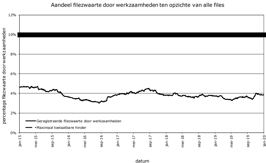
Figuur 6.1 Hinder veroorzaakt door werkzaamheden.
