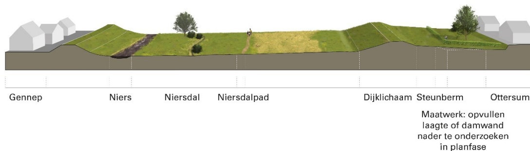
Afbeelding 26: Perspectiefdoorsnede dijkversterking deelgebied Niersdal
