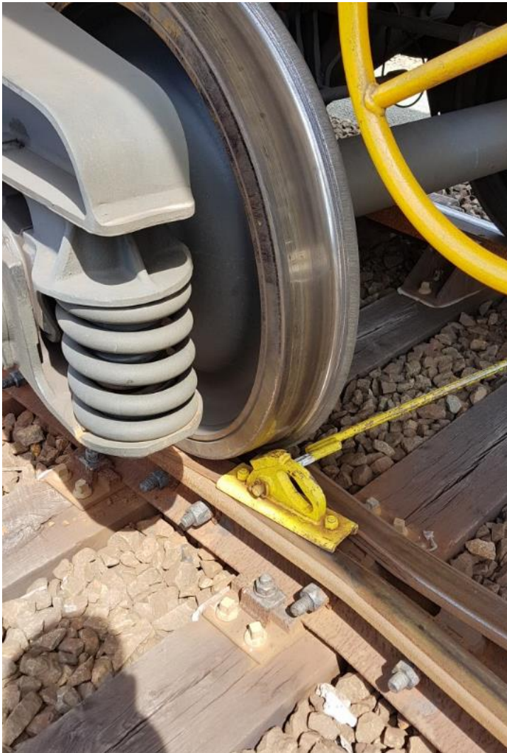
Afbeelding 2; Remslof (geel voor het wiel) zoals aangetroffen op incident locatie
