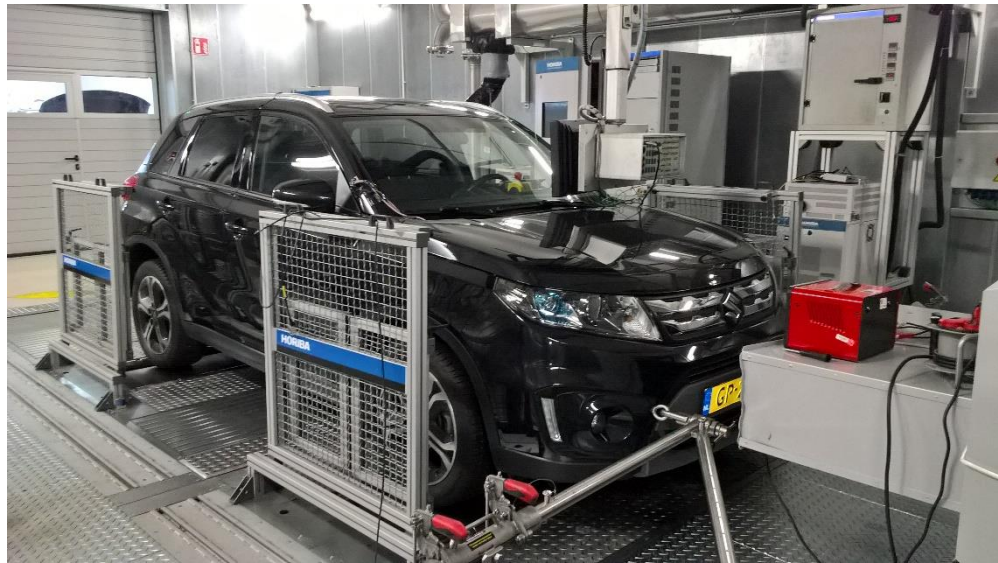
Figuur 3-2: Rollenbank en meetapparatuur voor het uitvoeren van een emissietest
