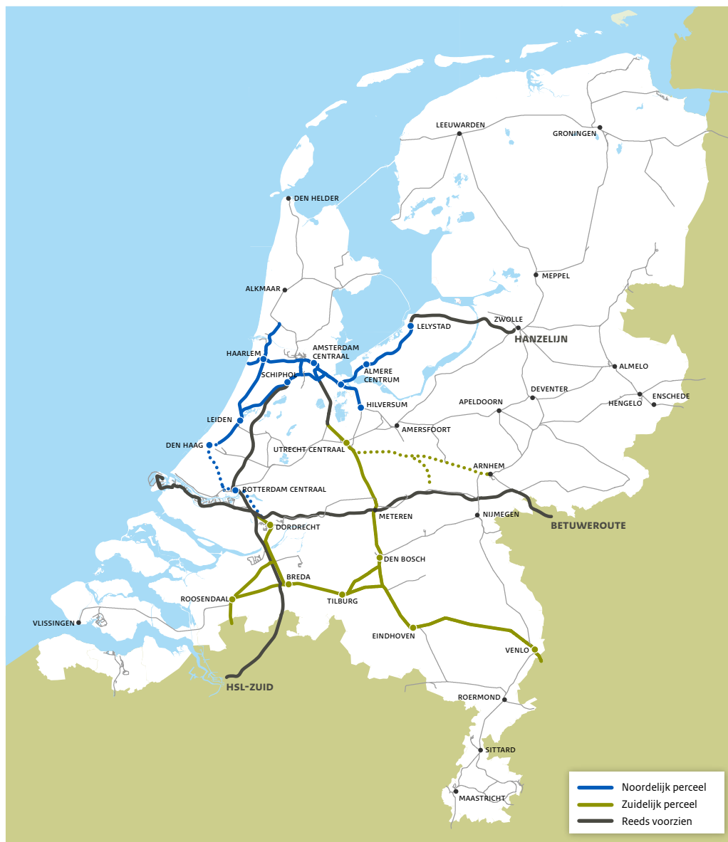
FIGUUR 010 Verwachte uitrol ERTMS in de infrastructuur in alternatief scenario I bij een budget van €2,33 mld. en eerstvolgende trajecten (als stippellijn).
