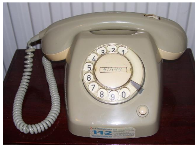
Figuur 3: Door PTT verstrekte telefoon met draaischijf: Ericsson T65
