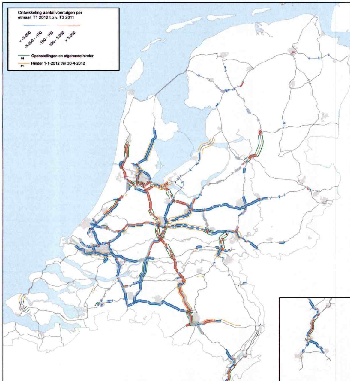
Figuur 1 Verschil in het aantal afgelegde kilometers. In de kaart betekent blauw een daling van de hoeveelheid verkeer en rood een stijging van de hoeveelheid verkeer ten opzichte van het vorige trimester.
