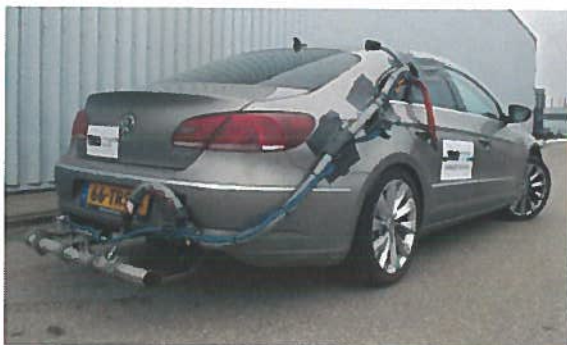
Een PEMS-systeem geïnstalleerd op een Euro 6 personenwagen.
