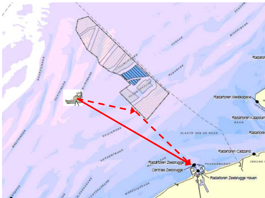
Figuur 88. Principe schets van multipath effect voor het RDF station van Zeebrugge
