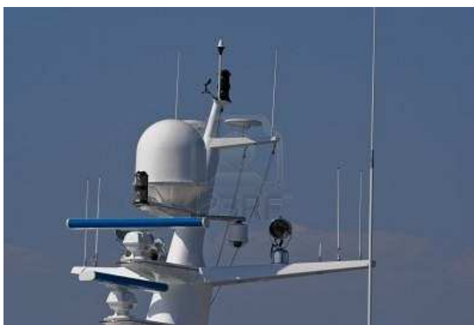
Figuur 74. Typische scheepsmast met radarantennes en communicatieantennes
