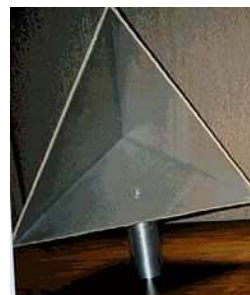
Figuur 49. Trihedral corner reflector: principe (links) en voorbeeld (rechts)
