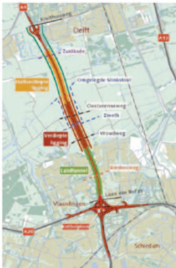
Abbeelding 3.1 Schematische ligging A4 Delft - Schiedam 1 = ligging maaiveld 2 = halfverdiepte ligging 3 = verdiepte ligging 4 = landtunnel
