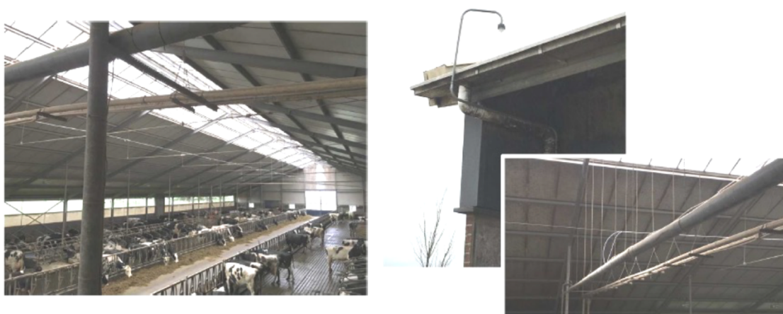
Afbeelding 2.2 De rechter en linker foto laten een voorbeeld van de monstername-leiding in de stal zien. De middelste foto laat een voorbeeld van een buitenmeetpunten zien.
