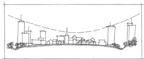
Principedoorsnede van het centrummodel met aflopende bebouwing die aansluiting zoekt bij het centrum.
