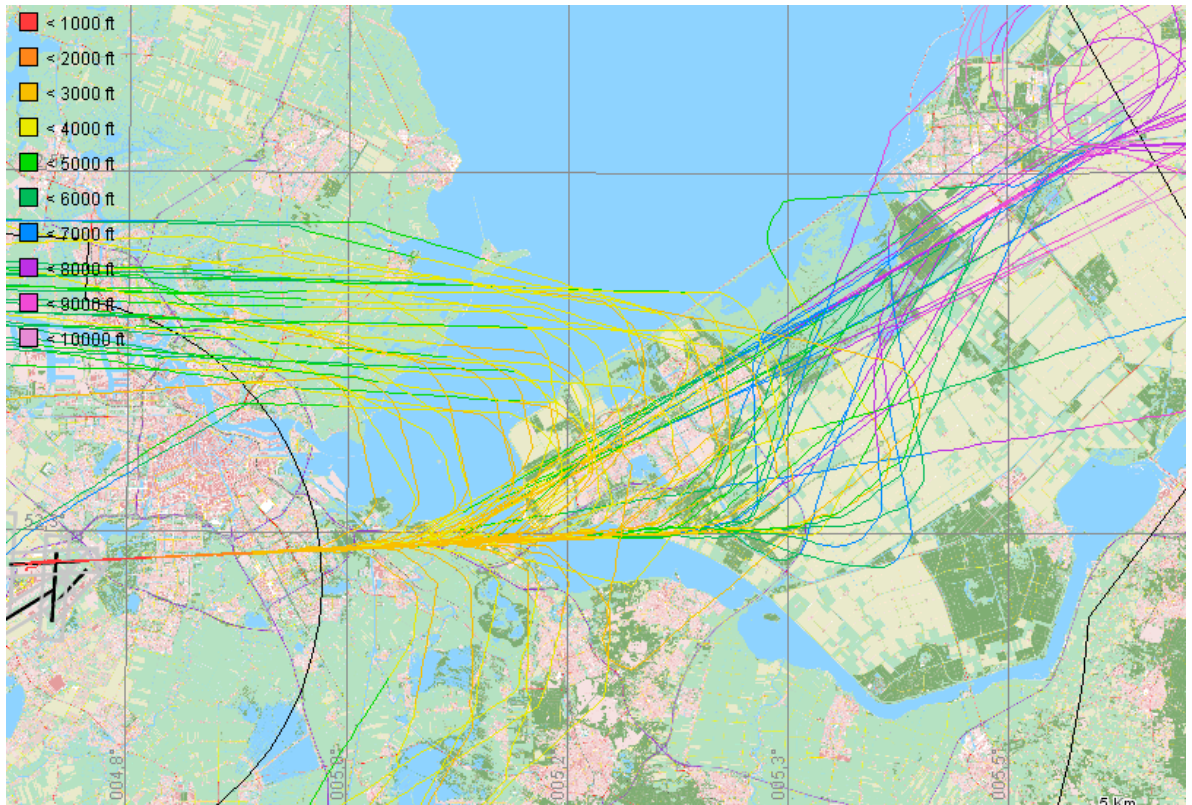
Figuur 23: Vectorpatronen Schiphol-verkeer bij landen 27 (Buitenveldertbaan) als enige landingsbaan bij harde westenwind (72 vluchten tussen 6.00 - 9.00 u LT op 9 december 2011).
