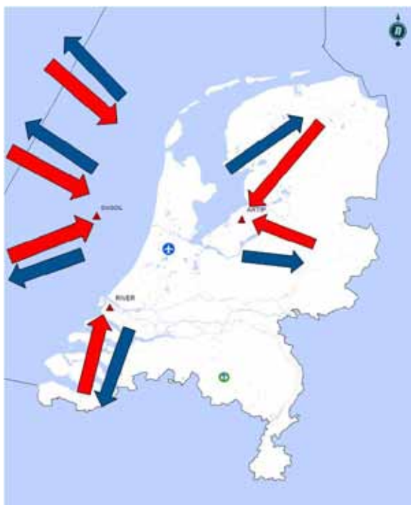
Figuur 29: Schets van CDO's via vaste naderingsroutes op Eindhoven Airport (te introduceren vanaf 2012) in relatie tot de operatie op Volkel.
