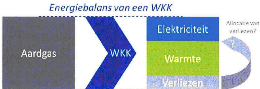
Figuur: Energiebalans van een WKK-installatie, betreft allocatie van verliezen over eindproducten (elektriciteit en warmte)
