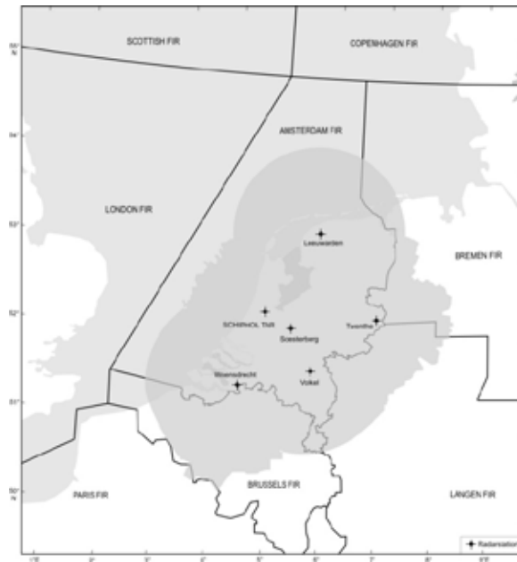
Figuur 1q: locatie en dekking rondzoekradars in Nederland.
