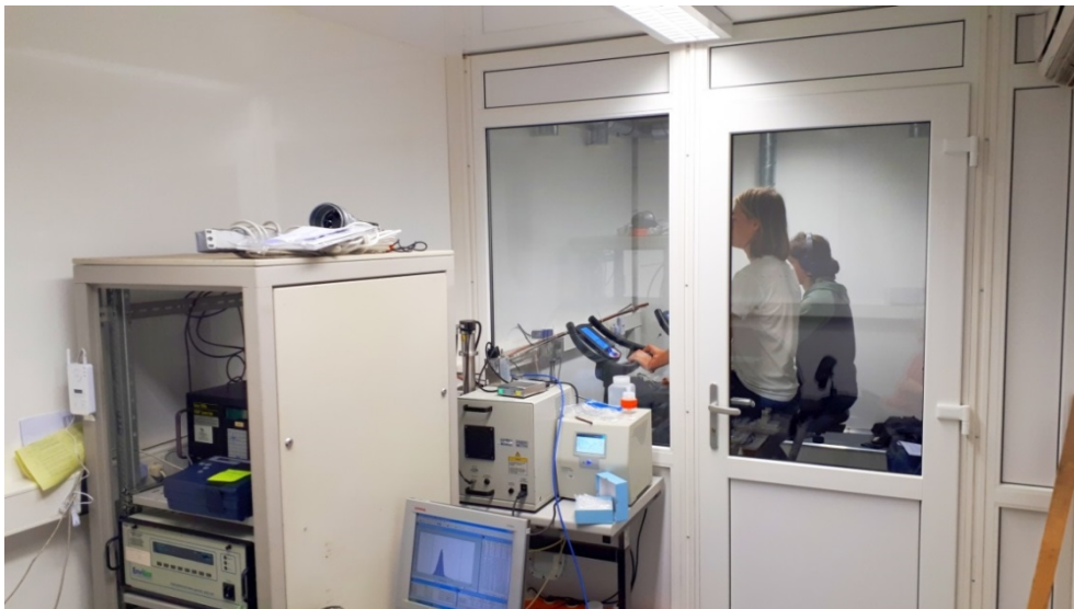
Figuur 4.4 Het interieur van het mobiele blootstellingslaboratorium bestaande uit een blootstellingskamer en een technische ruimte gescheiden door een glazen scheidingswand.
