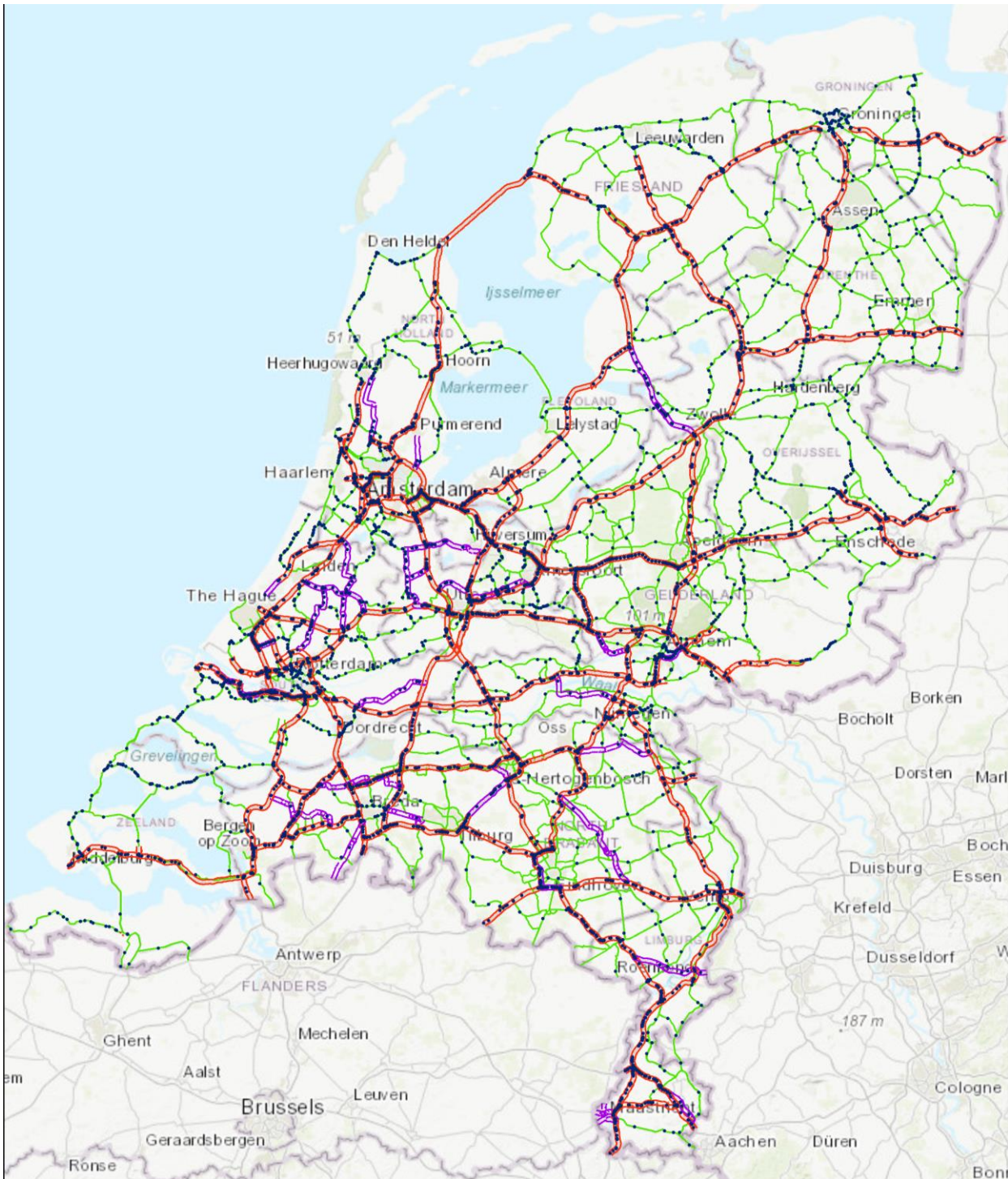
Figuur 2.2 Telpunten met lengteclassificatie (blauwe dots), geprojecteerd op het monitoringnetwerk (groen) en heffingsnetwerk (rood en paars). Stand van zaken november 2019.
