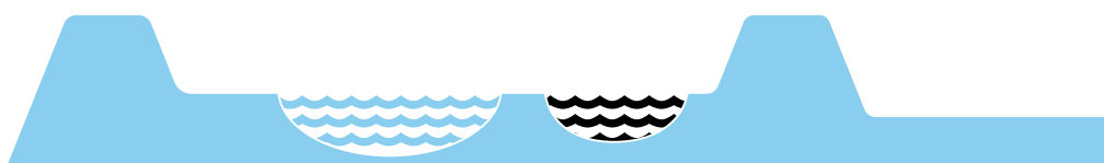
Rivierverruiming - in plaats van dijkversterking
