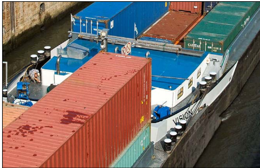
Koppelverband met zwaluwstaartverbinding (foto: Leo Schuitemaker)
