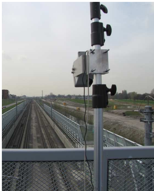
Figuur 1 Beeld van de radarsnelheidsmeter op het viaduct over het HSL spoor aan de Offenbachbaan.
