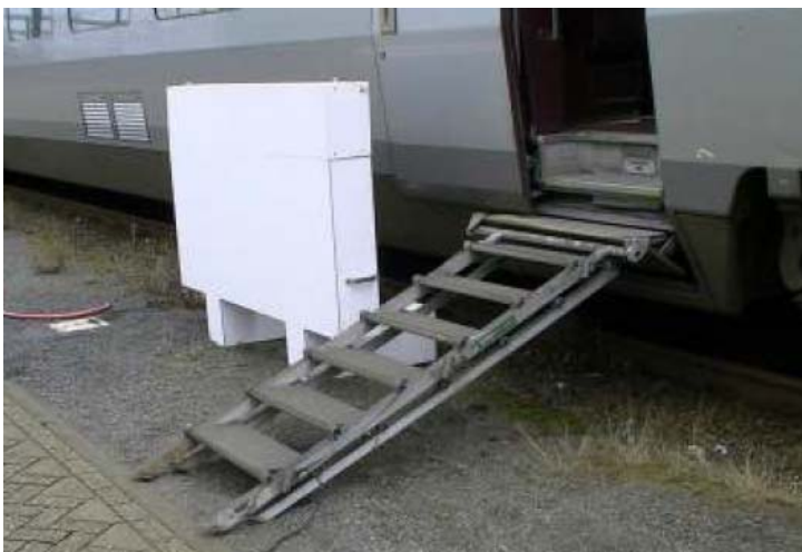
Figuur 6: Dummy van een halve MDM bij de evacuatietrap van de Thalys 1
