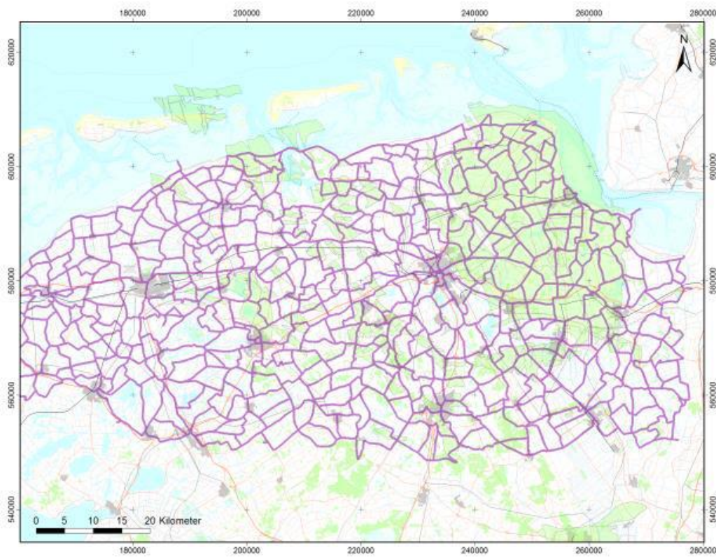
Waterpastraject voor bodemdalingsrapportage, ontleend aan [8.1]
