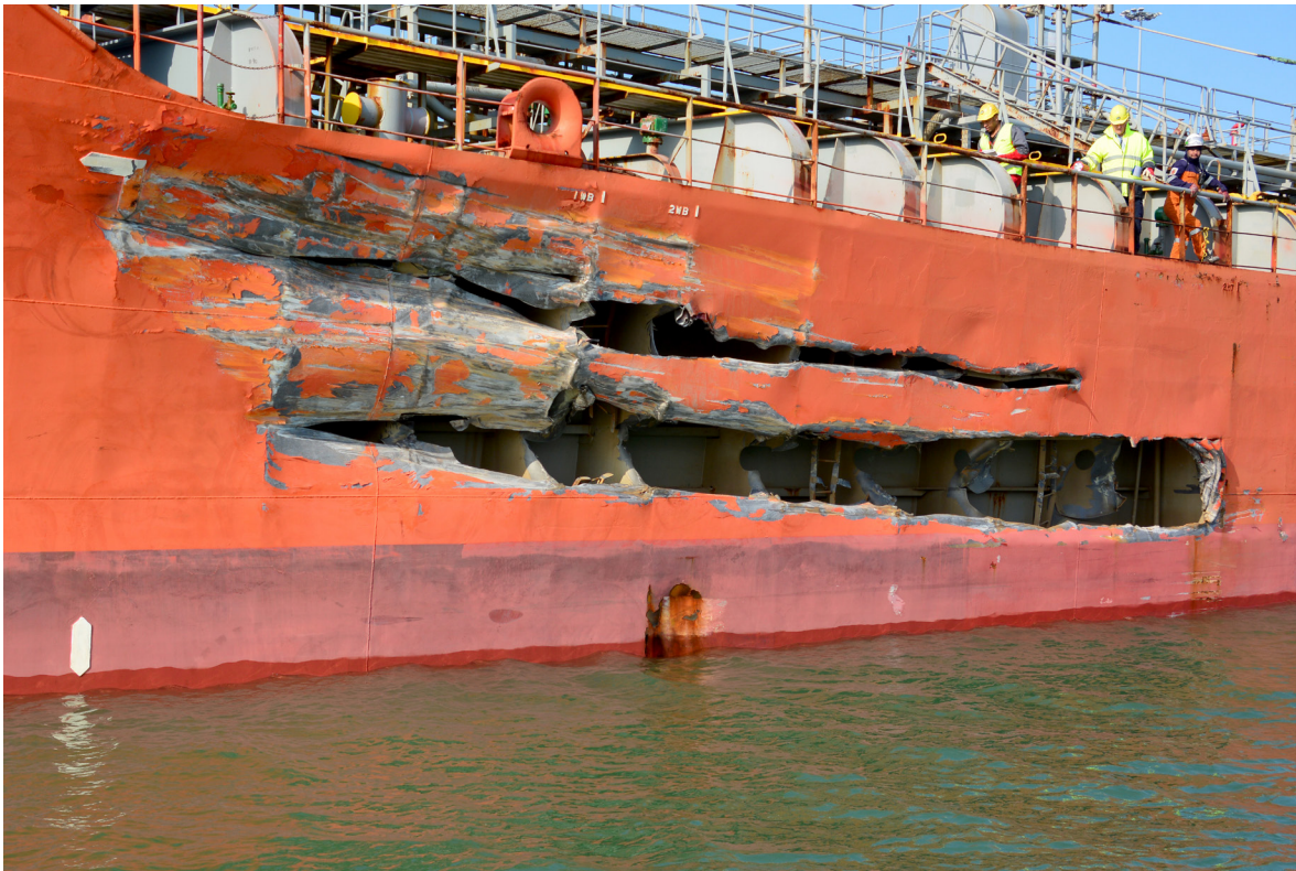
Figuur 8: Schade aan de Chemical Marketer na de aanvaring met de Viking Idun.
