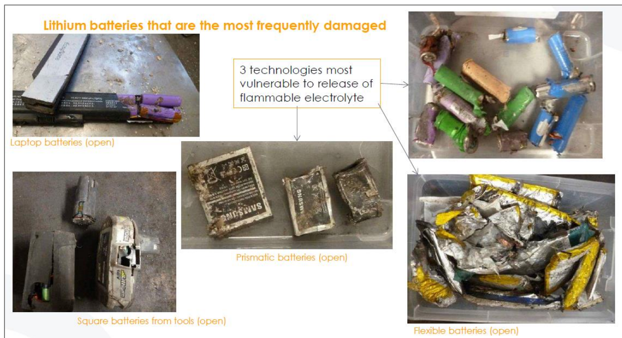
Figuur 16 Overzicht van de types van lithium-ion batterijen die het vaakst beschadigd worden (Bron: Ecosystem)
