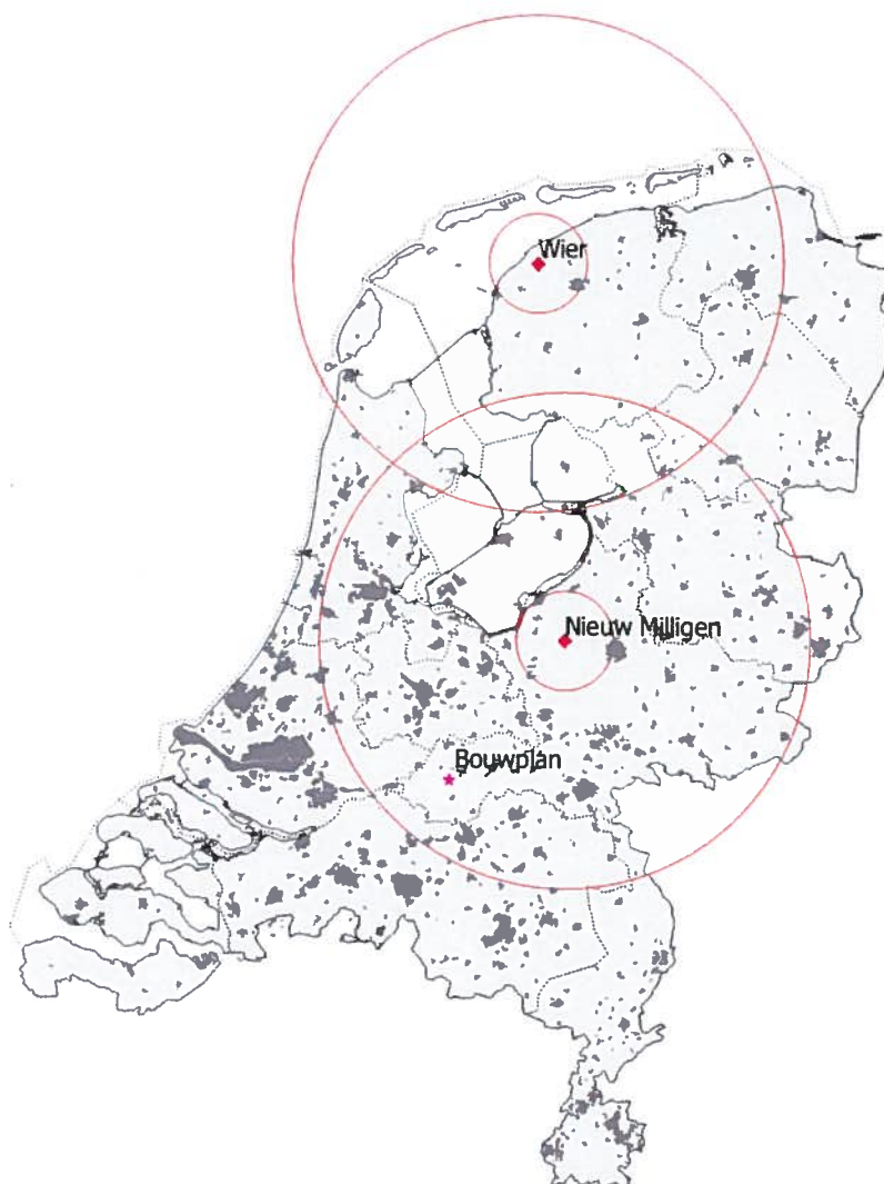
Figuur 3. Locaties van de twee MPR gevechtsleidingsradars (rode ruit) met daaromheen de 15 en 75 km cirkels. De donkergrijze vlakken zijn de in de AHN-1 gedefinieerde stedelijke gebieden. De ligging van het te toetsen bouwplan is aangegeven met een roze ster.
