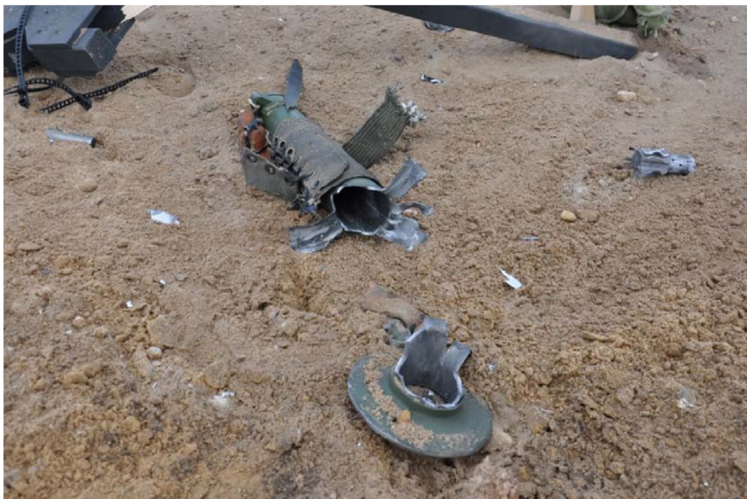
Foto 15 restanten van de mortier na afvuren van mortiergranaat met gewapende ontstek
