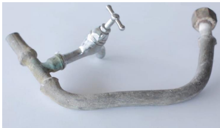
Figuur 3 : Loden leiding (bron: Drinkwaterplatform)
