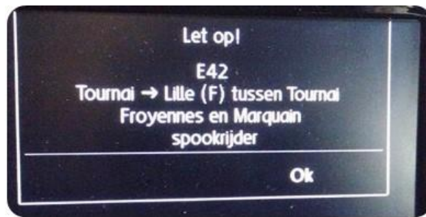
Figuur 26. Voorbeeld van een melding over een spookrijder op een in car display
