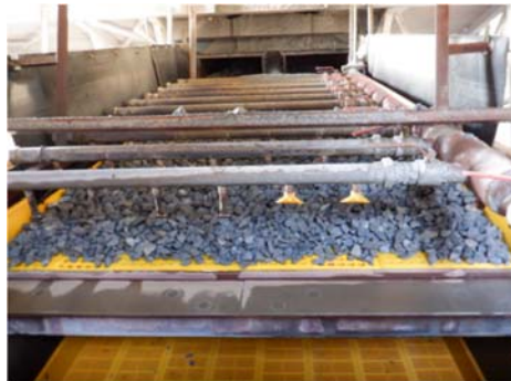
Lessines: 1 wasser met 10 buizen x 6 sproeiers
