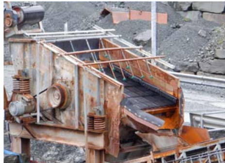
Seljestokken: 1 wasser met 3 buizen x ca 4 sproeiers
