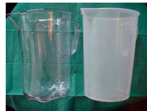
Afbeelding 7 Vervorming urineverzamelbokaal ten gevolge van een desinfectieproces
