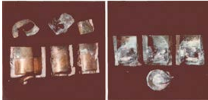
Figuur 14 Messing cupjes (links) en aluminium slaghoedjes (rechts) uit schokbuizen V-19 afkomstig uit de Nederlandse Antillen [Josseling de Jong, 1976].
