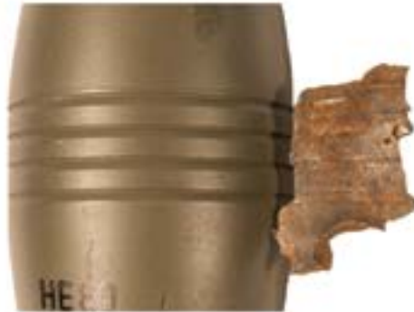
Figuur 22 Afdruk op fragment van de schietbuis, afkomstig van de groeven op de mantel van de hoofdvlading op het moment van de reactie van de hoofdvlading.
