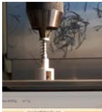
Figuur A.2 Detail van opstelling met huis, veer en slagpin/begrenzer combinatie.
