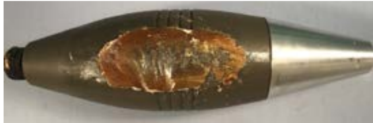
Figuur 19 HE80 mortiergranaat met TNT exudaat.
