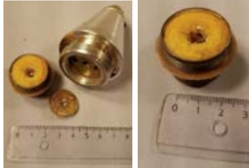
Figuur 3 Foto's van de schokversterker die na de doorslagtest is gedemonteerd.
