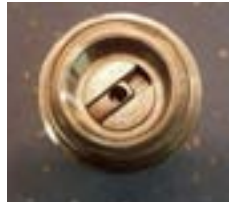
Figuur 4 M6-N schokbuis met sluiters in gewapende stand.
