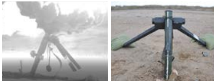
Figuur 25 Deflagratie bij lancering van de mortiergranaat met 5 mm aanboring in de mantel [2].
