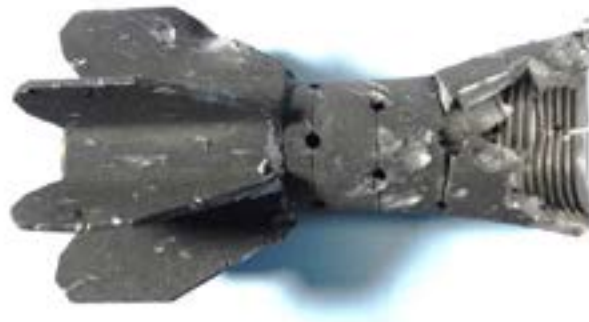
Figuur 30 Teruggevonden staartstuk HE80 mortiergranaat na TNO experiment in 2012.
