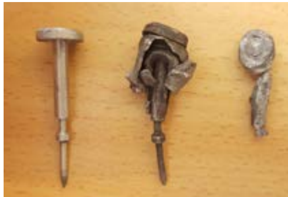
Figuur 8 Slagpin ongebruikt (links), uit de test in gewapende stand (midden) en uit het ongeval (rechts).
