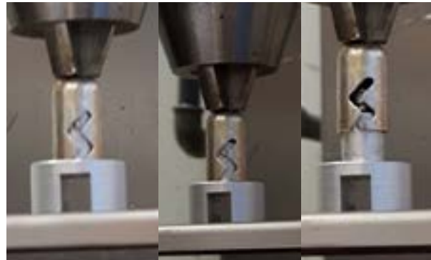
Figuur A.5 Detail van opstelling met huis, veer en terugslagkap combinatie overeenkomend met een verplaatsing van 3,2 mm, 4,1 mm en 11,1 mm in Figuur A.4.
