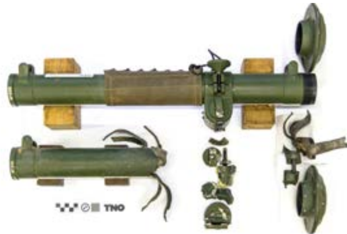
Figuur 1 Reconstructie gevonden delen schietbuis No. 513 (onder) en een intacte schietbuis No. 500 (boven).
