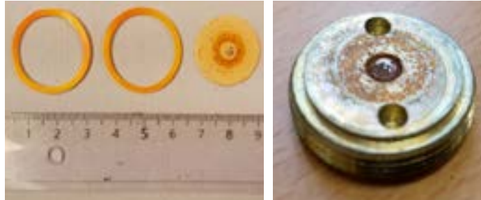
Figuur 26 Verkleuring van O-ringen en karton (links) en afzetting op de onderzijde van de afsluitplaat (rechts) in de M6-N schokbuis gebruikt bij de 70 °C doorslagtest.
