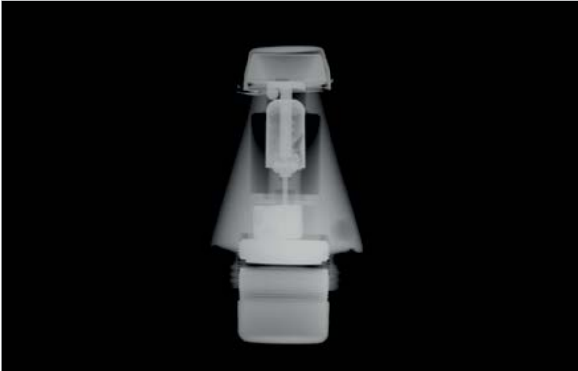
Figuur K3: Röntgenfoto van de schokbuis in de veilige stand. (Foto: Defensie)
