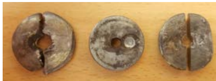
Figuur 10 Bovenzijde van de afsluitplaat uit de test in gewapende stand (links), uit een test in ongewapende stand (midden) en uit het ongeval (rechts). De afsluitplaat uit de test in gewapende stand is gebroken als gevolg van de detonatie, de afsluitplaat uit het ongeval is in zijn geheel teruggevonden, maar is doorgezaagd voor nader onderzoek.
