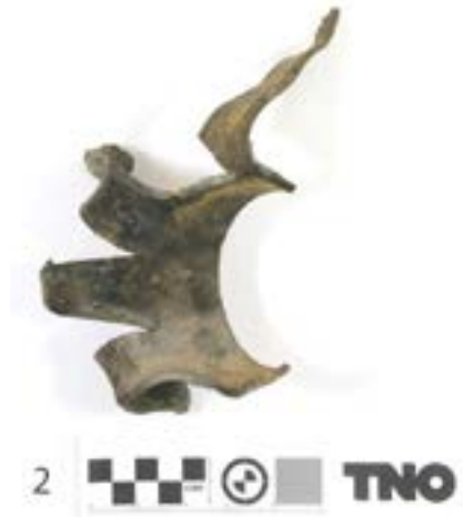
Figuur 17 Teruggevonden onderste deel schietbuis.
