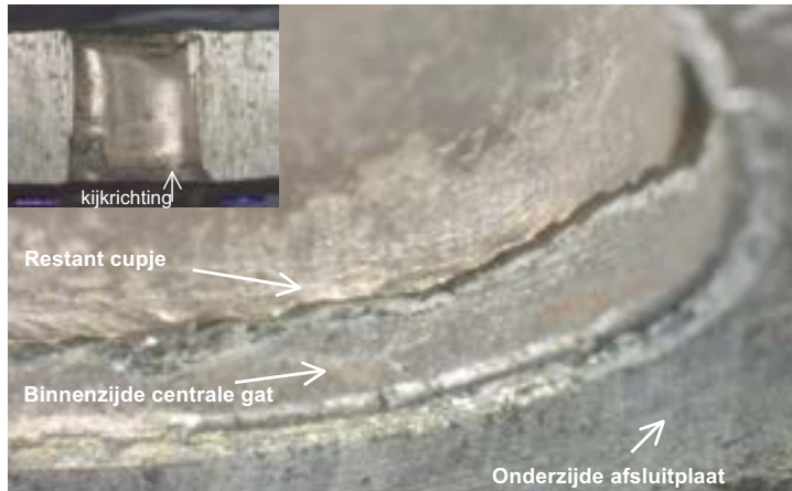
Figuur 8 Onderrand cupje overdrachtslading aan de binnenzijde van een van de helften van het centrale gat. Inzet: indicatie van de richting waarin de hoofdfoto is genomen.
