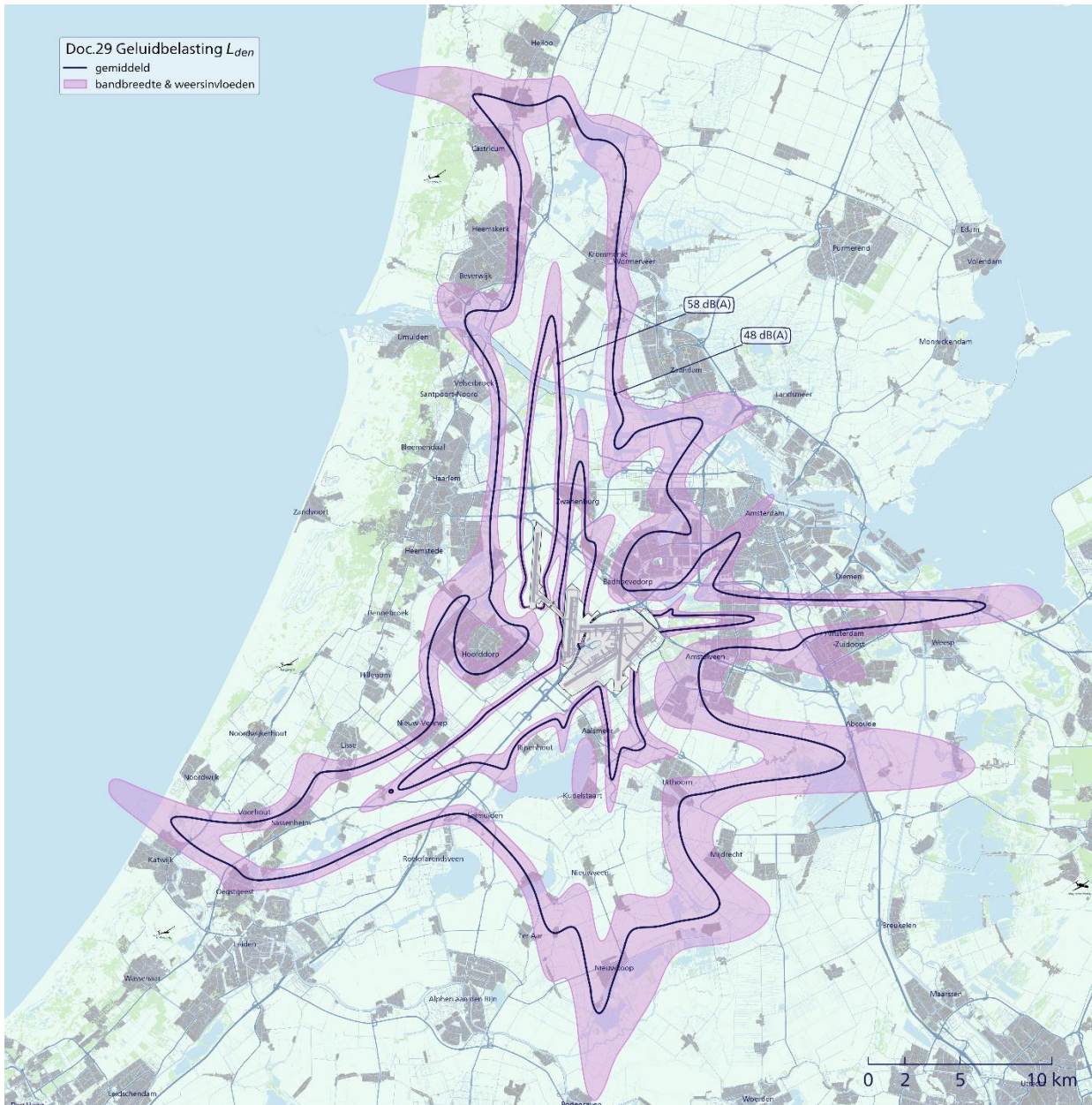
Figuur 5.1: Verwachte jaargemiddelde geluidbelasting met spreiding als gevolg van bandbreedte in verkeersaantallen en weersvariaties (Doc.29).
