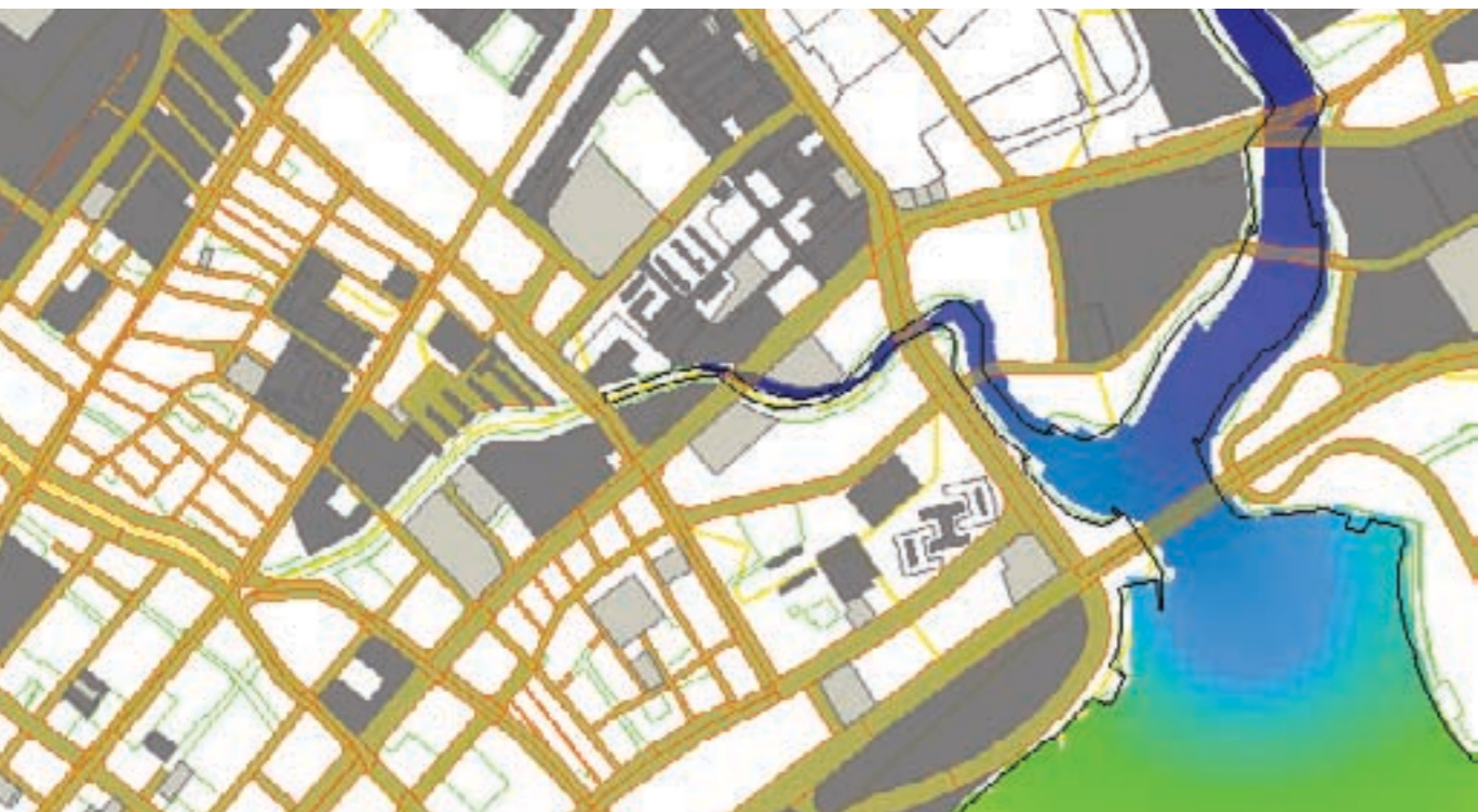
Modellering in Delft3D van het zoutgehalte in het Marina Reservoir, Singapore
