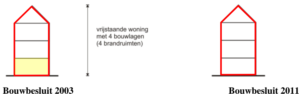
figuur 5.2-1 Locaties met sterkte-eisen m.b.t. bezwijken binnen een vrijstaande woning
