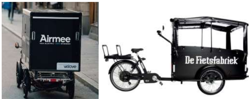
Afbeelding 1. Voorbeelden van zware e-bakfietsen voor goederenvervoer (links) en personenvervoer (rechts) (Foto links: Velove; rechts: De Fietsfabriek) 4
