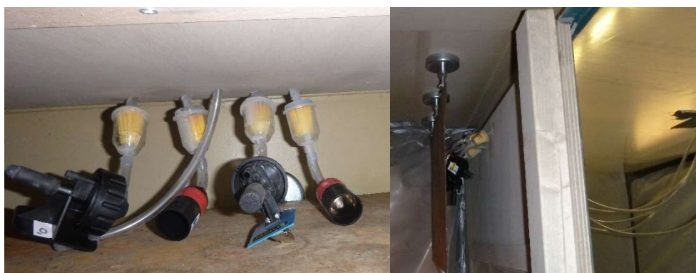
Figuur 8: Opstelling monsternamekoppen voor het meten van asbest en respirabel stof tijdens straalexperimenten.
