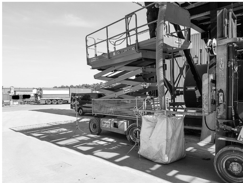
Meetlocatie 2B: Overzichtsfoto vullen van een bigbag vanuit een grote vulsilo, inclusief positie stationaire meetpunten dichtbij vulopening (proxi voor persoonlijke meting) en verder vanaf de vulopening. De vulsilo wordt van bovenaf bediend.
