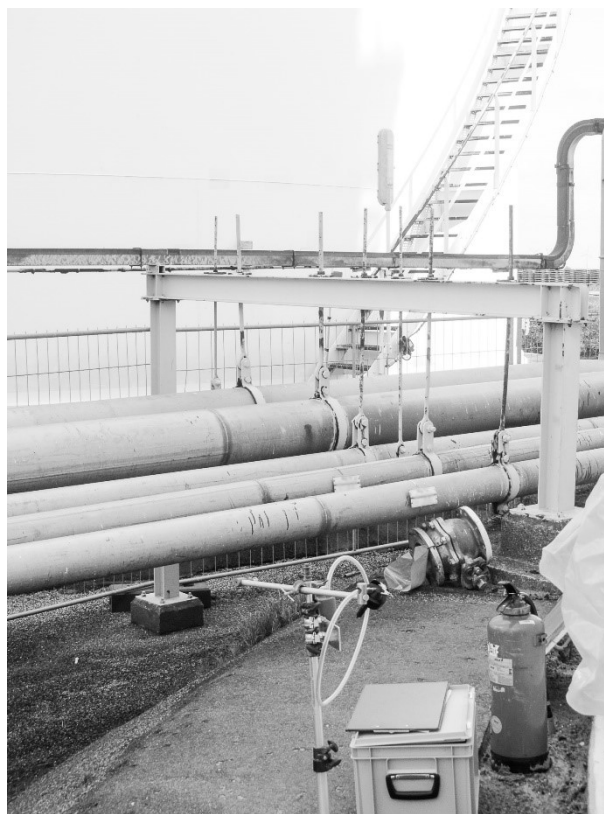
Meetlocatie 1C: Posities stationaire meetpunten bij mangat (<1 en >5 m)
