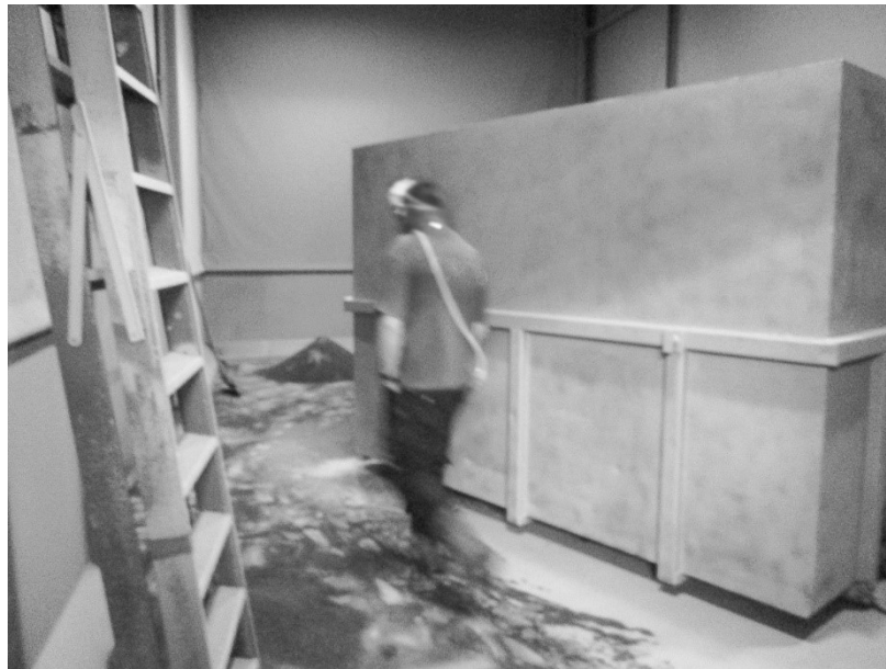
Meetlocatie 3: Nabootsen verplaatsen / inspectie in de straalcabine (lopen door gebruikt straalgrit op de vloer van de straalcabine)
