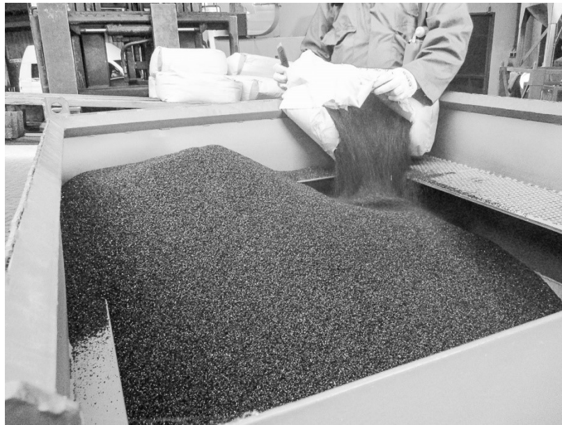
Meetlocatie 3: Vullen van vulsilo met zakken
