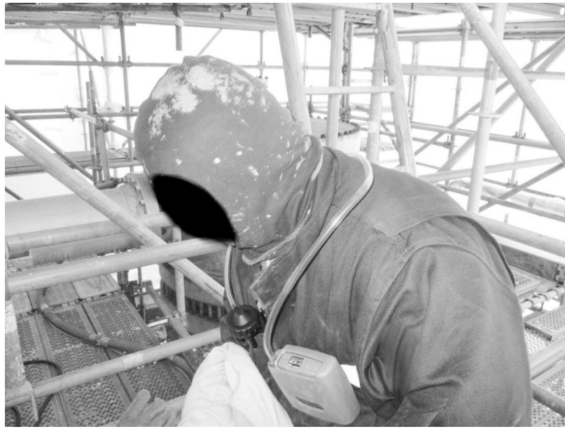
Meetlocatie 1B: Voorbereiding persoonlijke meting onder de straalkap bij straler
