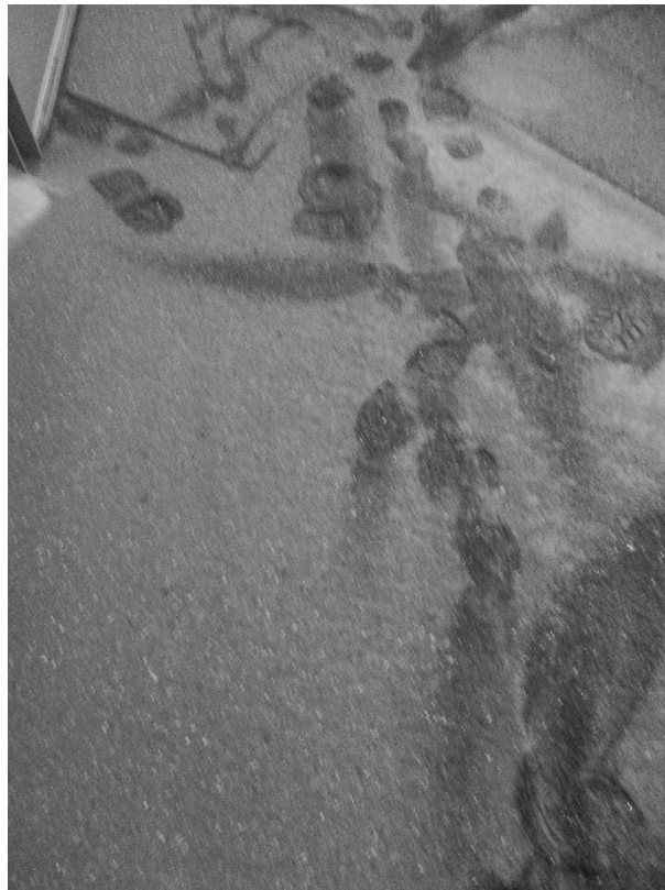
Meetlocatie 3: Voetstappen door laagje gebruikt straalgrit op de vloer van de straalcabine na nabootsen verplaatsen / inspectie
