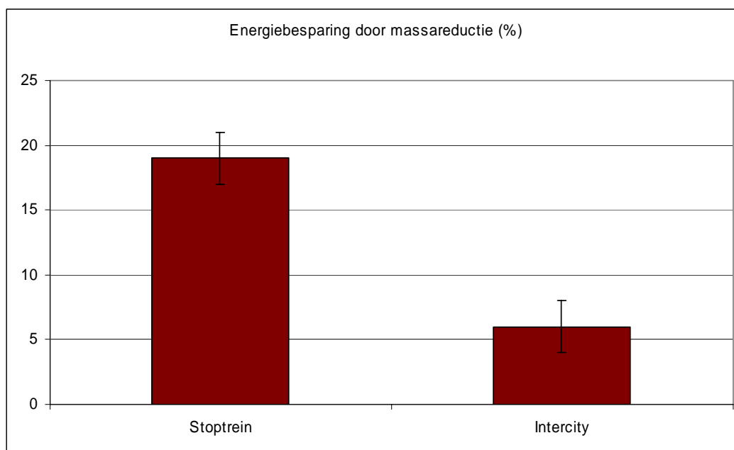
Figuur 19 Energiebesparing trein door massareductie
