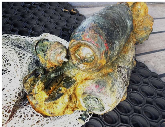
Figuur 46 3" mortier granaten (M7) met restanten ontstekers.
