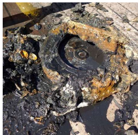
Figuur 68 Amerikaanse AT mijn (M18) na verwijderen transportverpakking
