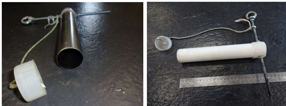
Figuur 72 Roestvast stalen (links) en polypropyleen (rechts) steekbuizen met een diameter van 40 mm die gebruikt zijn voor monsternamen uit de waterbodem.
