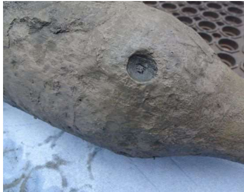
Figuur 51 Holte in omhulsel van 4,2" springrook mortiergranaat (M8).
