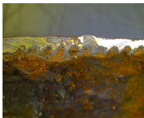
Figuur 58 Detail schroefdraad M10-2 (radiale doorsnede).
