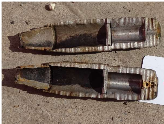
Figuur 24 M3-1 na doorsnijden in lengterichting. Holte voor tracer en schroefdraad zijn goed zichtbaar.
