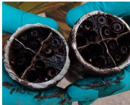
Figuur 56 Dwarsdoorsnede van de M10 raketmotor met buisjes rookzwak kruit.
