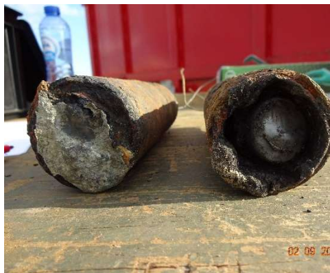
Figuur 55 Voorkant van raketmotoren met grotendeels vergane afsluitdop.
