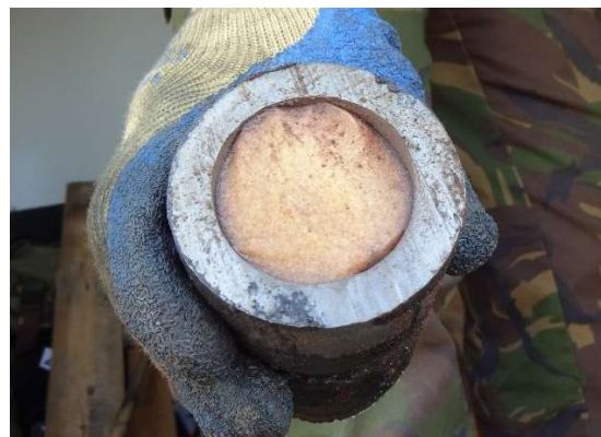
Figuur 39 Doorgesneden TLV granaat met explosieve lading nog intact.
