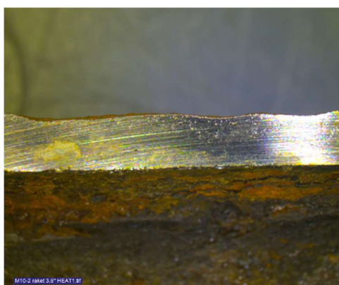
Figuur 57 Detail wanddikte M10-2 (radiale doorsnede).
