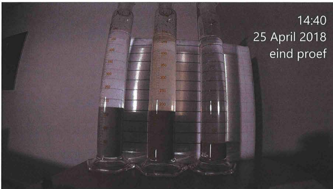
Figuur 5: De toestand 49 uur na het begin van het bezinken. Het bovenstaande water is na 69 uur bezinken met een sifon overgebracht in door Deltares verschaft kunststof flessen voor watermonsters en het vaste stofgehalte van die watermonsters is bepaald.
