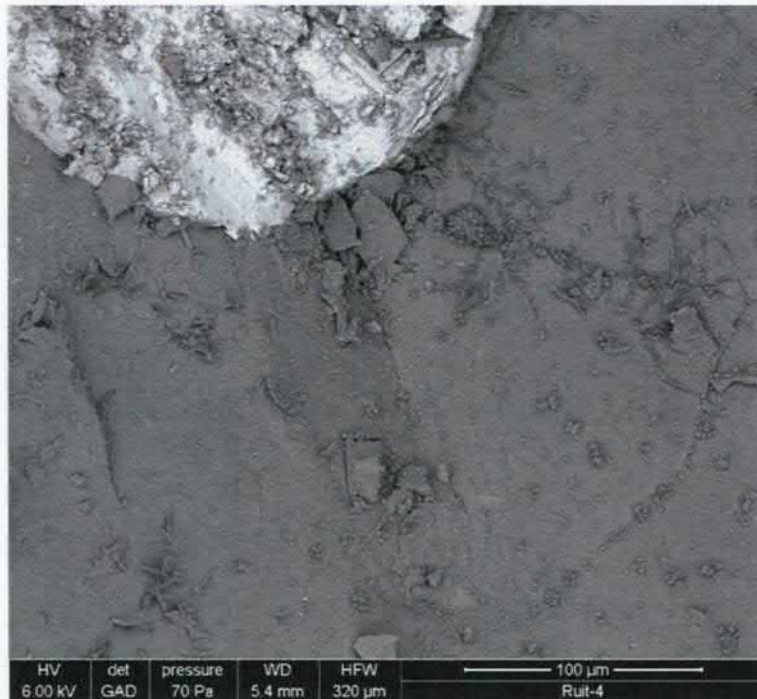
Figuur 5.14: Ruit 4. SEM opname van radiale barsten in het glas rond het NiS insluitel. Het vertakte object rechts van het insluitel is een schimmel. Talrijke fijne deeltjes op het breukvlak
