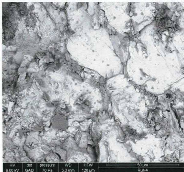
Figuur 5.13: Ruit 4. Detail van het insluitel. De lichte delen zijn NiS, de donkerdere delen daartussen zijn glas
