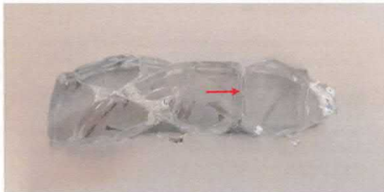
Figuur 5.8: Ruit 5. Vlinderpatroon; de rode pijl geeft het breukvlak met inluisel aan
