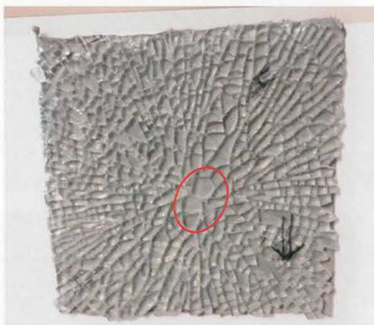
Figuur 5.4: Ruit 4. Vlinderpatroon centraal in het monster
