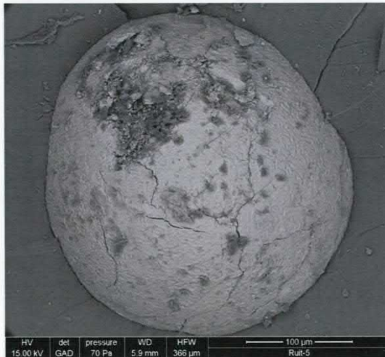
Figuur 5.20: Ruit 5. SEM opname van het insluitel op het centrale breukvlak van het vlinderpatroon. EDS analyse laat zien dat het om NiS gaat
