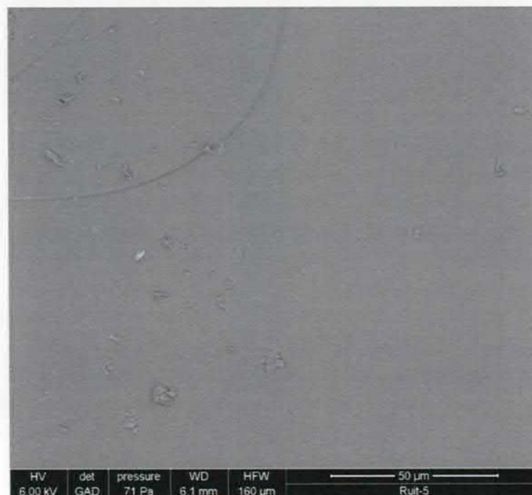
Figuur 5.21: Ruit 5. SEM opname van het breukvlak in het glas rond het NiS insluitel. Duidelijk verschil in structuur van het glas en afwezigheid van de neerslag in vergelijking met ruit 4 (figuur 5.15 tot en met 5.18)
