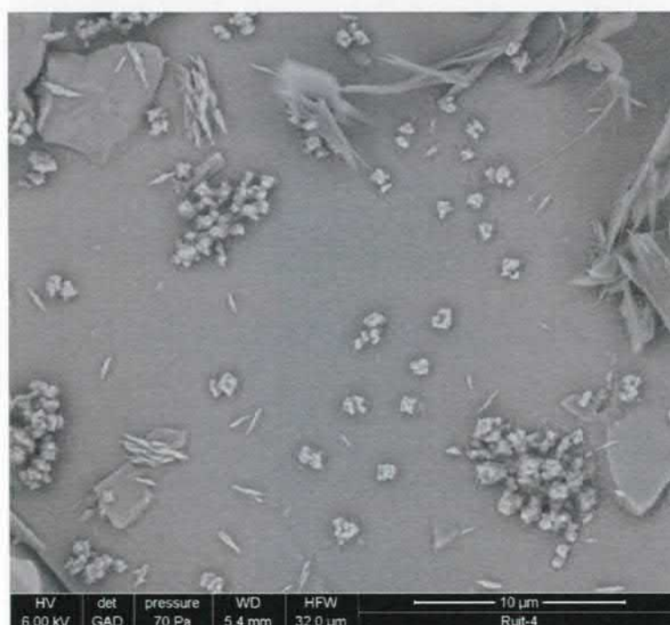
Figuur 5.15: Ruit 4. SEM opname van de neergeslagen deeltjes op het breukvlak
