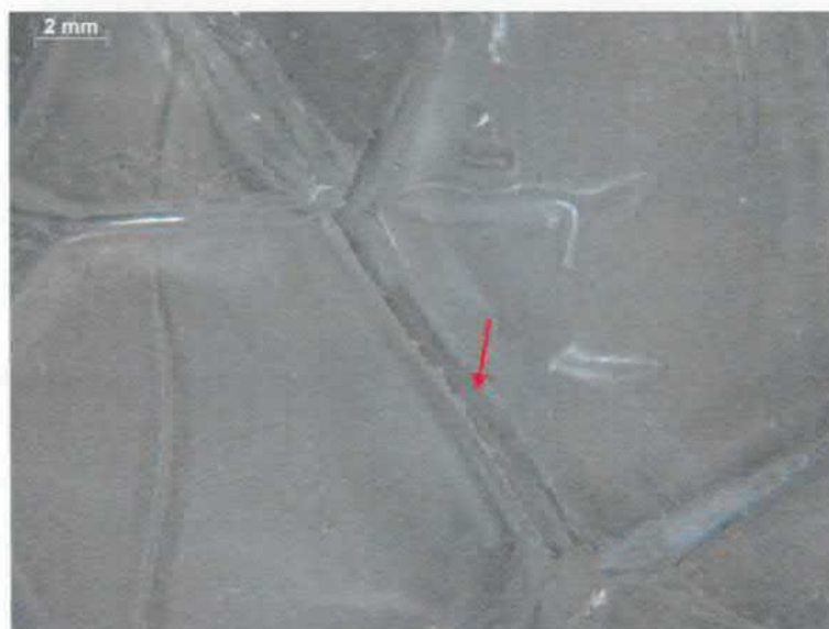
Figuur 5.9: Ruit 5. Stereomicroscopische foto van het centrale breukvlak in het vlinderpatroon met de locatie van het inluisel
