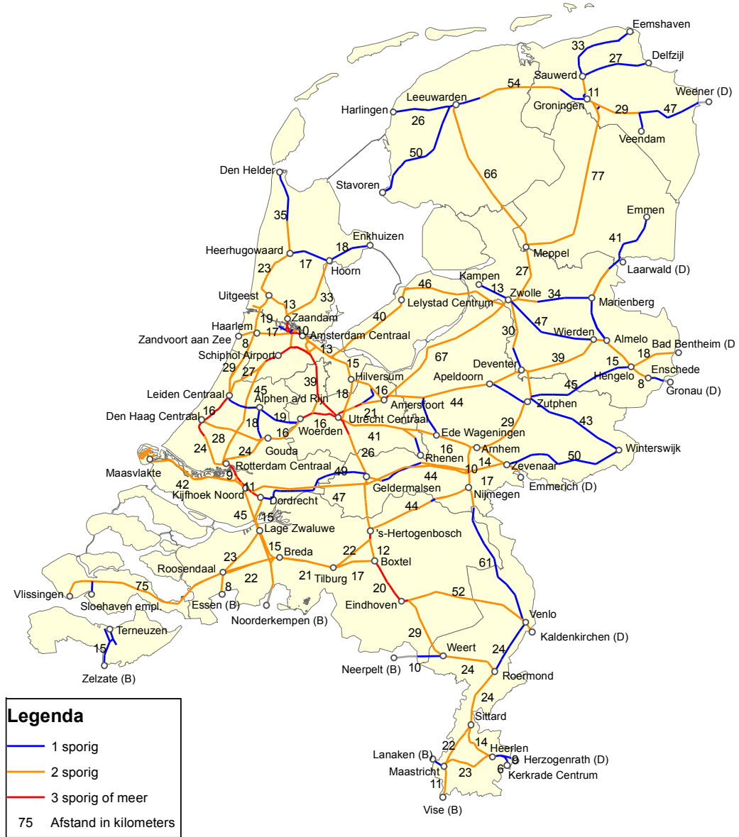
Figuur A.1: Algemene overzichtskaart met netwerkconfiguratie van het hoofdspoor (Situatie januari 2018). Uit: ProRail Netwerkverklaring 2018, Bijlage 1.
