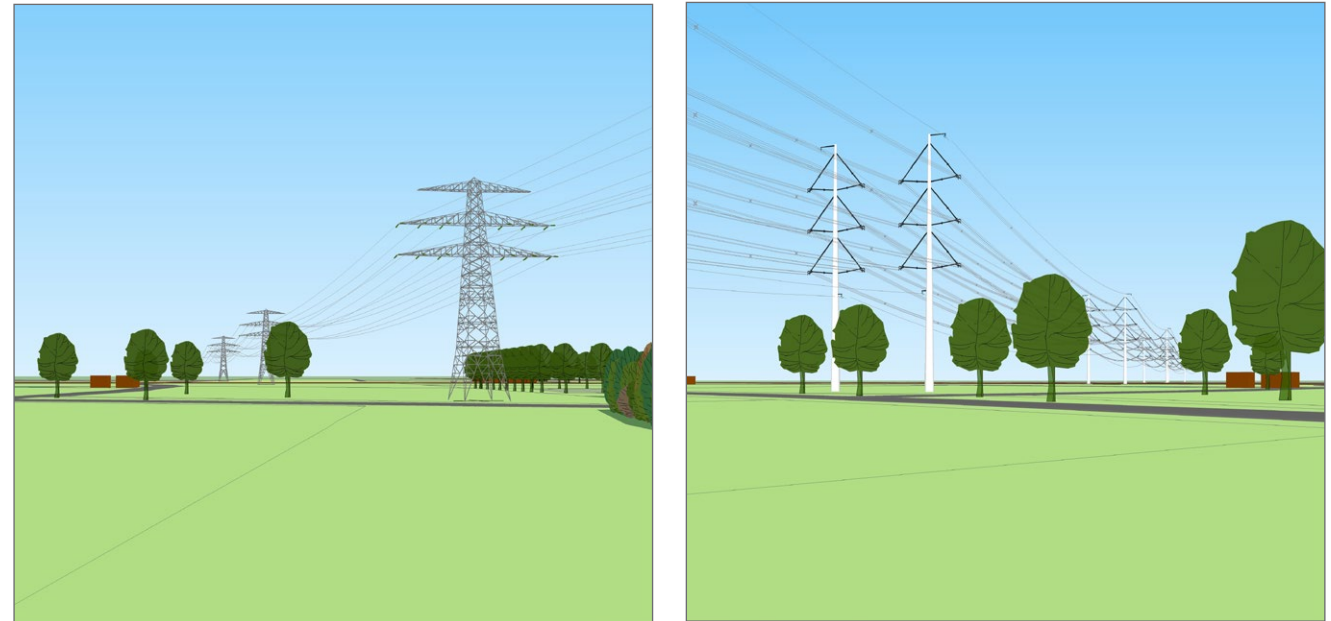
fig: 5 Vereenvoudigde lijnbeelden. Links vakwerk 4x220kV, rechts wintrack 4x380kV
