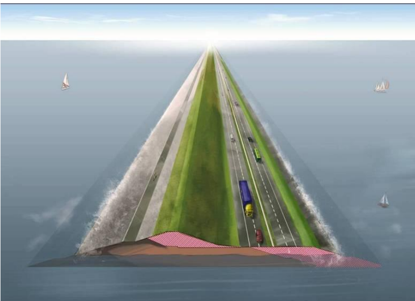
Figuur 4.2 2100-Robuust (21R): illustratie doorsnede van verhoogd en verbreed dijklichaam
