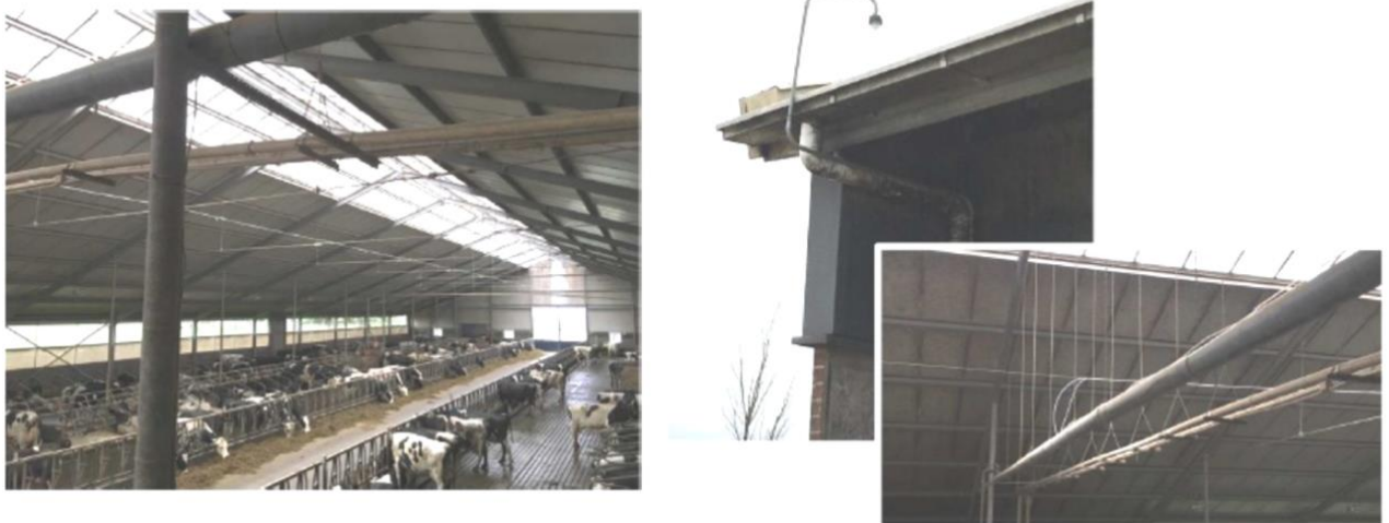
Figuur 4: De rechter en linker foto laten een voorbeeld van de monstername-leiding in de stal zien. De middelste foto laat een voorbeeld van een buitenmeetpunt zien.
