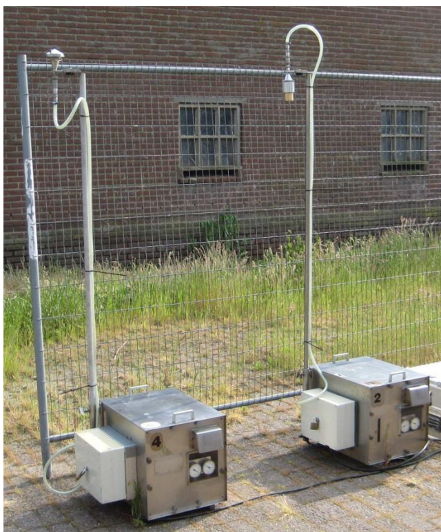
Afbeelding B2.1 Luchtmonsterneming bij De Klomp met “low volume” samplers en aparte filterkopjes voor Nuclepore filters (rechts) en Millipore MCE filters (links)
