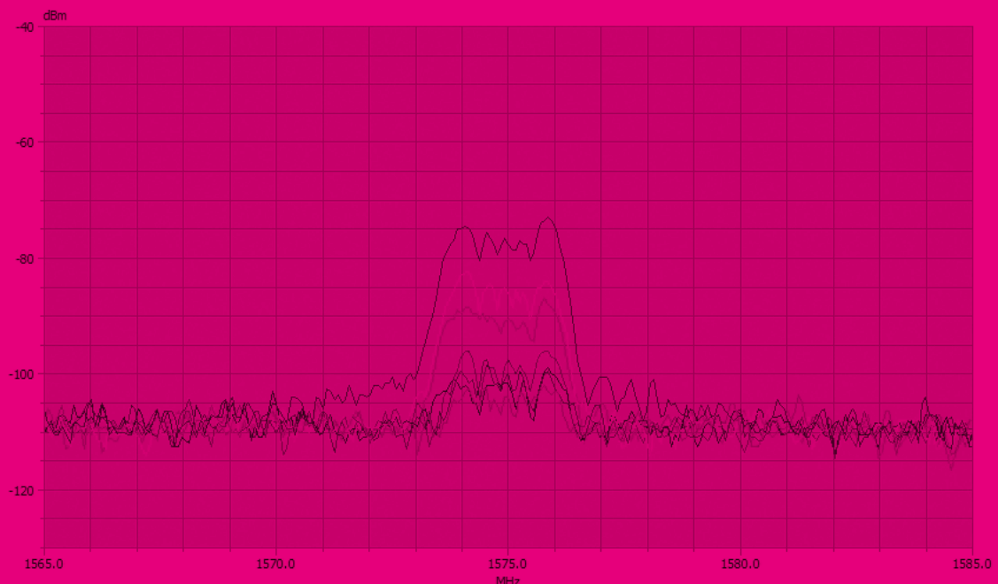
Figuur 7 GPS-sigitaal afkomstig van een satelliet is zo zwak dat het in principe niet waarneembaar is aan de hand van veldsterktemetingen. Jammers verstoren het frequentiespectrum door lokaal over een bepaalde breedte in het spectrum een signaal uit te zenden. In de praktijk ziet dat er uit als een 'blok' in het frequentiespectrum.
