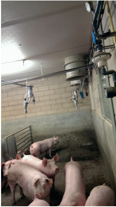
Meetopstelling met meetkoppen voor PM10 en Dusttrack. De losse meetkop links op de linker foto is de 'veldblanco' voor het bepalen van de endotoxinen. Hierdoor wordt geen lucht aangezogen.
