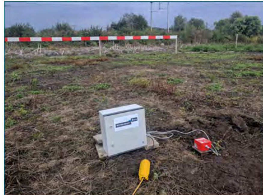
Afbeelding I.1 Trillingsmeter beperkt ingegraven
