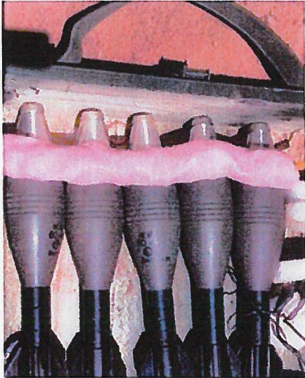
Foto 6: Mortiergranaten 60 mm HE-80 met ongewapende ontsteker voorbereid voor gecontroleerde vernietiging. (Foto: KC W&M)
