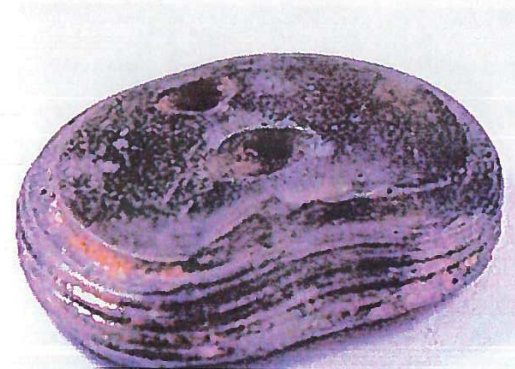
OVV-rapport figuur 26: Uitvergroting van de afsluitplaat afkomstig van de Ongevalsgranaat. (Foto: TNO)
