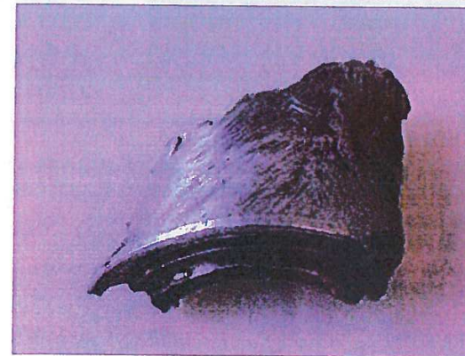
Foto 2: Buitenzijde scherf met sporen van detonatie. (Foto: KC W&M)
