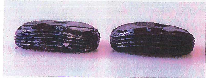
Foto 8: Links afsluitplaat OVV-rapport; rechts afsluitplaat gecontroleerde vernietiging. (Foto: KC W&M)
