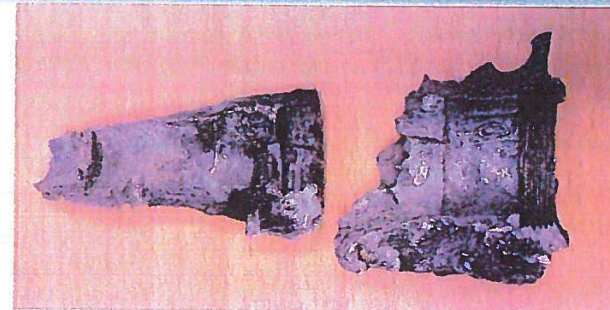
OVV-rapport figuur 10: Afdruk van de sluitersluiterveer op de binnenwand van de geteste schokbuis in de gewapende stand (links) en op de binnenwand van de schokbuis van de ongevalsgranaat (rechts) (Foto TNO).
