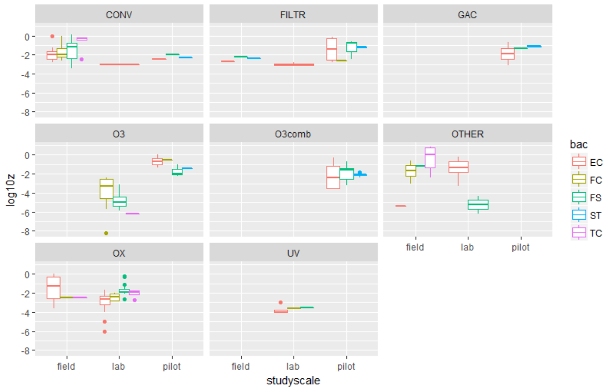
Figuur 9-8: Box-whisker plots van de log verwijdering van bacteriën door afvalwaterzuivering per bacterie en per type afvalwaterzuivering.
